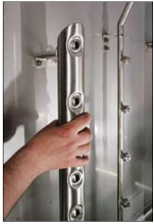
Dubbele verticale wasarmen met niet-verstoppende nozzles om de gecombineerde stroom van water en granulaat te vergroten.
