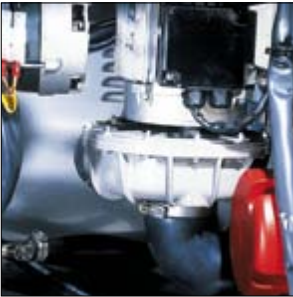
De zeer krachtige waspompen zijn verticaal geplaatst. Daardoor zijn ze zelfledigend en blijft er geen waswater in de pompen staan.
