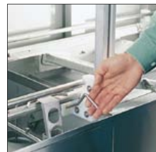
Alle tanks kunnen geleege worden met één hendel. Alle onderste afvoeren en ook de overlooppijp sluiten automatisch als de deur in de spoelzone is afgesloten.
