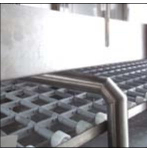
De turbo-blowers blazen de lucht door de openingen die aan de zijanten en het lager liggende gedeelte van de band zitten.
