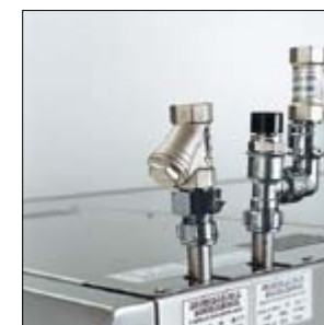
De achterwand is glad en uit één stuk. Alle wateraansluitingen zitten aan de bovenkant. Omdat alle service en onderhoud aan de voorkant gebeurt, kan de machine bijna tegen de muur geplaatst worden.
