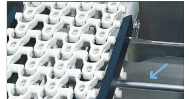
Om de hygiëne verder te garanderen hebben alle RHIMA stations standaard een bandlift functie. Deze functie kan zowel handmatig (standaard) geopend en gesloten worden of met een timer. De kettingband schoonmaken is makkelijk, doordat het vuil los blijft zitten als gevolg van de constante spoeling.
