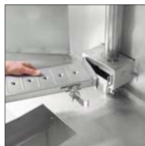
Lichtgewicht wasarmen kunnen eenvoudig verwijderd worden voor reiniging.
