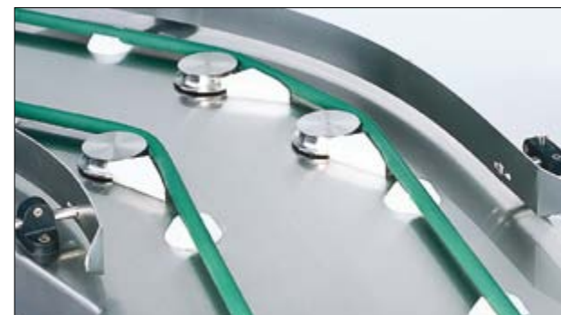
De ronde polycord RHIMA dienbladen transportband is stil en betrouwbaar. Dankzij de open constructie is deze ook makkelijk schoon te houden. De levensduur van de met metaal versterkte ronde polycord is verlengd en de noodzaak voor service is minimaal.
