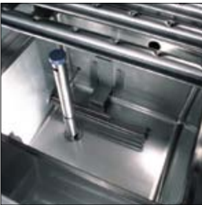
De wasarmen zijn bevestigd met snelkoppelingen waardoor ze eenvoudig te verwijderen zijn voor reiniging. Door de zelfreinigende nozzles van de wasarmen hoeft dit niet dagelijks te gebeuren. Zijwas- en naspelarmen zorgen voor maximaal hygiënisch resultaat.
