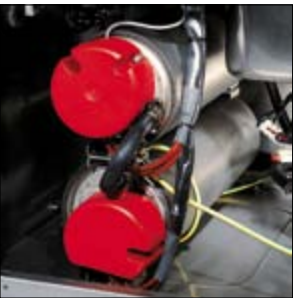
Net als de andere onderdelen van de machine zijn ook de boilers uitgevoerd in AISI 316 RVS. De boilers zijn volledig geïsoleerd en het verwarmingselement zit in het midden. Hierdoor gaan er geen warmte en energie verloren. De machines werken standaard op warm water van 50 graden, door plaatsing van extra boilers of een energierugwinningsinstallatie kan machine ook op koud water worden aangesloten.
