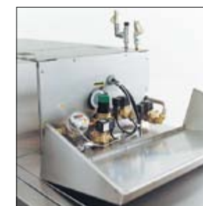
De compressieklep, magnetische kleppen en de waterniveaumeters voor de naspoeling bevinden zich achter een scharnierdeur.
