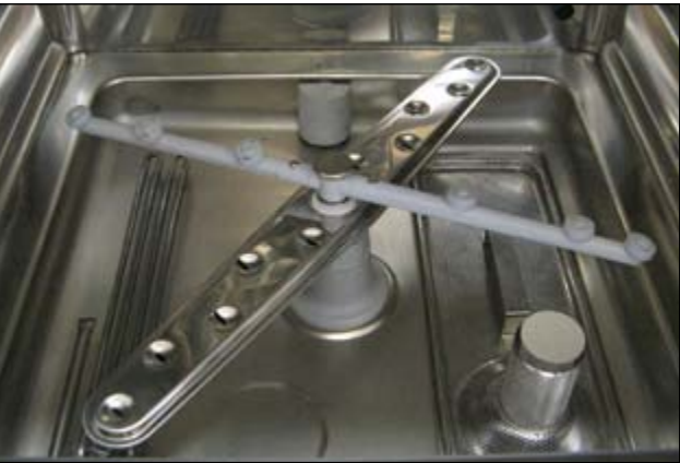
Nieuw: diepgetrokken wastank en roestvrijstalen filter.
