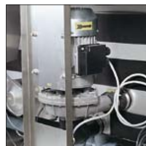
Wanneer de machine geleegd is, blijft er geen waswater over in de pompen wat de hygiëne ten goede komt.
