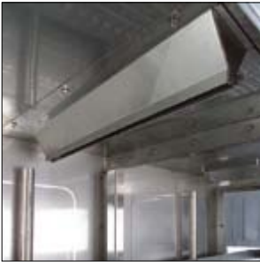
Verselbare opening om de kracht van warme lucht uit de droogzone te regelen.
