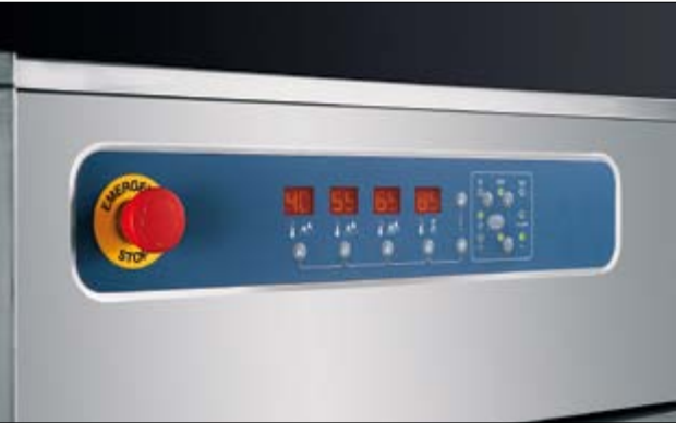
Een laag voltage controle paneel, met easy touch toetsen, stelt u in staat om de temperaturen en de status van de machine in de gaten te houden. Het zelf-diagnose systeem laat een alarm zien mochten er temperatuur- of functionele fouten gebeuren (alles volgens HACCP normen). De software om alle functionele data op te slaan is optioneel leverbaar. Om de operationele kosten te verminderen, zijn alle modellen uitgerust met een Auto-timer, die pompen, de motor van de band en alle geïnstalleerde opties op stand-by zetten na een vooraf ingestelde tijd.
