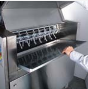
Invoerzone met beveiligde deur en makkelijk schoon te maken oppervlakte filters.
