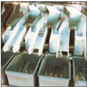
De automatische besteksorteermachine verdeelt het bestek automatisch in de juiste bestekboxen die dan teruggebracht worden voor gebruik.
