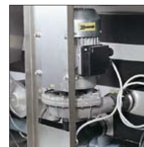
Als de machine wordt geleege, blijft er ook geen water in de pompen, waardoor de hygiëne verbeterd.
