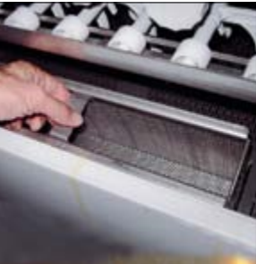
Boven het waswaterniveau in de wastanks zijn gemakkelijk uitneembare roestvrijstalen vuilzeven geplaatst.
