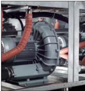
Optionele turboblowers. Zorgen ervoor dat er een verwaarloosbaar percentage vocht op het oppervlak van de vaat achterblijft.
