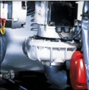
Zelfreinigende verticale waspompen met een grote capaciteit.
