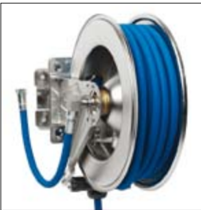
Slanghaspel RVS slanghaspel, open model, uitgevoerd met 10m of 15m 1/2" "food service quality" slang. De complete haspel is zeer eenvoudig te installeren door de bijgeleverde draaibare muurplaat. Geleverd incl. 50cm aansluitstang. Maximale werkdruk 10 bar en maximale werktemperatuur 80°C.
