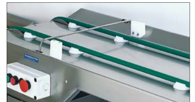
Er is een melder aan het eind van de band gemaakt om er zeker van te zijn dat er geen vaat op het dienblad blijft staan voordat ze gestapeld worden. Onnodige breuk van vaat kan zo vermeden worden.
