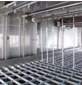
Naspoelonderbreker met rooster van synthetisch materiaal. Voorkomt schade aan het meest delicate porselein.
