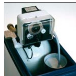
Bovenaanzicht waterontharder, zonder deksel. Vooraan de niveau-regelaar, daarachter de harstank met datum/tijd klok. Zoutoplossing vindt plaats in het voorste gedeelte.
