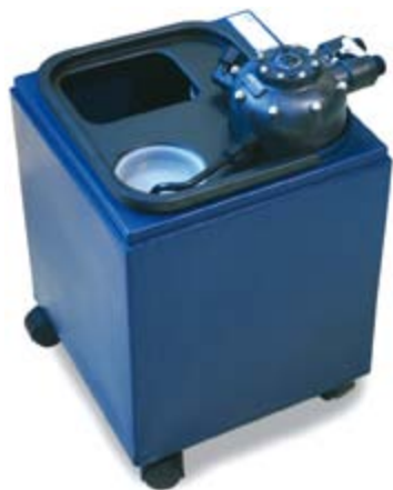
Bovenaanzicht ontharder, zonder deksel. Het zout wordt linksboven bijgevuld. Het kunststof kabinet is op wielen gemonteerd zodat reiniging onder de installatie eenvoudig is. De installatie is snel en eenvoudig te monteren.
