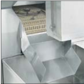
De vaatwasser voor bestek annex sorteerder bevat een systeem waarin wassen en sorteren in de bestekbakken gebeurt zonder het bestek ook maar aan te raken.
