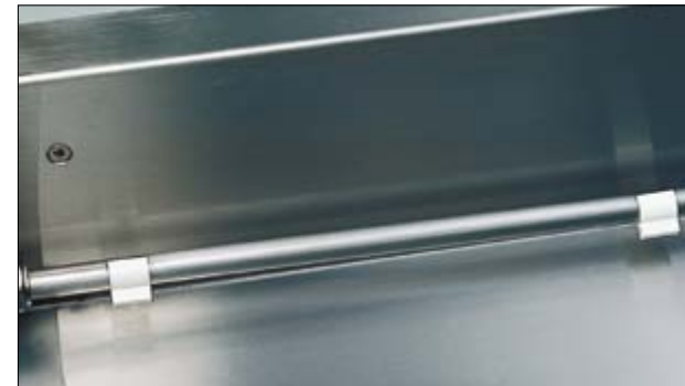
Om hygiëne in de bakken te garanderen hebben alle RHIMA stations standaard een tafelsproeiing. De functie kan gebruikt worden door handmatig (standaard) de sproeier open en dicht te zetten of dit met een timer te doen. De etensresten die van de borden vallen worden zo al gedurende het debrasseren weggespoeld naar de bodem van de bak en naar de zeef. De hygiëne van de unit en het voorkomen van onplezierige geurtjes worden zo onder controle gehouden.
