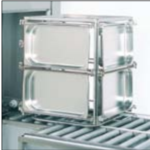
De cassette schuift gemakkelijk over de grote rollers van de aanvoertafel.
