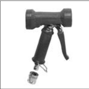
Spuitpistool Spuitpistool met 1/2" binnen-draad. Voorzien van geïsoleerde blauwe mantel en gele markeringen voor de straalrichting. Maximale werkdruk 24 bar en maximale werktemperatuur 80°C. Wordt geleverd met 1/2" aansluitnippel en snelkoppeling.
