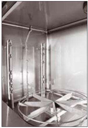
De korf wordt op een roterende ondergrond geplaatst om de werking van het granulaat op de te wassen oppervlaktes te vergroten.
