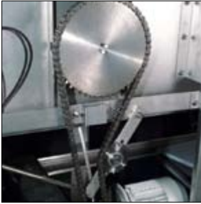
Standaard is de machine uitgerust met twee transportsnelheden en beveiligd door middel van een slipkoppeling. Tegen meerprijs kan een frequentieregelaar voor de band geleverd worden, zodat de bandsnelheid naar wens van de gebruiker kan worden ingeregeld.
