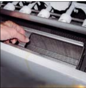
In alle RHIMA krattenwasmachines houden oppervlaktefilters het waswater vrij van grove vervuiling. In de wastank zijn vóór de pompen nog extra filters geplaatst om de pompen vrij te houden van vervuilend materiaal dat toch door de oppervlaktefilters heen komt.
