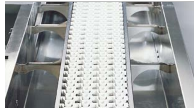
RHIMA automatische debrasseer- en sorteerstations, ook wel hoog-laag systemen genoemd, hebben altijd een open hygiënische kettingband. Dankzij de open kettingband constructie is het mogelijk de band schoon te maken zonder schoonborstelen of optillen van de band. De steunen van de band blokkeren het schoonmaken niet. De bodem van de bak loopt schuin af naar de zeef.
