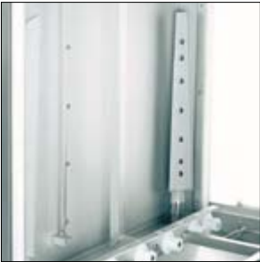
De draaiende cassette wordt bewassen door 4 wasarmen.
