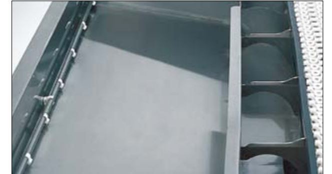
Als de korvenroosters weggehaald zijn is de bak geheel vrij waardoor het schoonmaken makkelijk is. Dankzij de schuine wanden verzamelt al het afval zich op de bodem van de sorteerunit.
