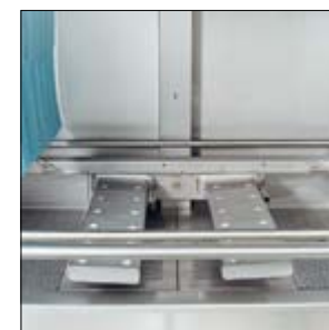
De wasarmen kunnen gereinigd worden door eenvoudigweg de snelvergrendeling los te maken - er hoeven geen andere onderdelen uit elkaar gehaald te worden.
