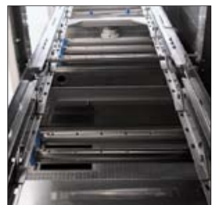
De machines hebben een dubbel aanvoersysteem om een vloeiende voortgang van de korven te garanderen.
