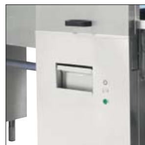
De voorwasmachine heeft een grote zeef welke eenvoudig uitneembaar en reinigbaar is, zelfs wanneer het wasproces doorloopt.
