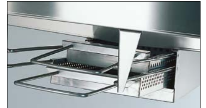
Grote zeven voorkomen dat de afvoer verstopt raakt door op een efficiënte manier de etensresten van de vloeistof te scheiden. Als optie is een dubbele zeef mogelijk, waarvan de gaten van de bovenste zeef groter zijn dan van de onderste.
