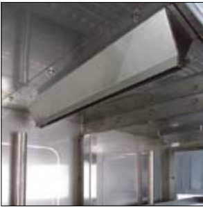
De bovenste uitblaasopeningen van de droogtunnel staan onder een hoek om het verwijderen van water van elk soort oppervlakte te optimaliseren.
