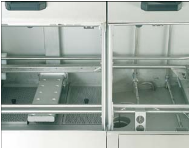
Grote roestvrijstalen vuilzeven houden het waswater lange tijd schoon.
