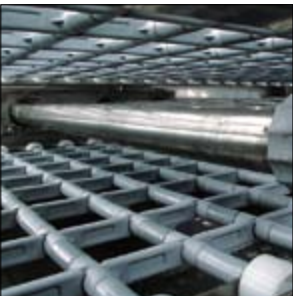
De wasarmen zijn door middel van een bajonetsluiting snel en gemakkelijk uitneembaar. De sproeiopeningen zijn zelfreinigend. De boven- en onderdruk van de wasarmen is instelbaar.
